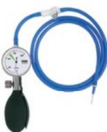
**Poire de gonflage pour brassard roulant /** Manomètre 200 mmHg, tube de connexion 100 cm avec raccords « positive locking » (PLC) et aiguille de gonflage
