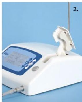
2 Se abre el brazo basculante con el alojamiento integrado del tubo.
