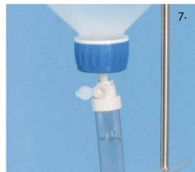
7 Abrir la válvula de purga situada debajo de la cámara de goteo.
