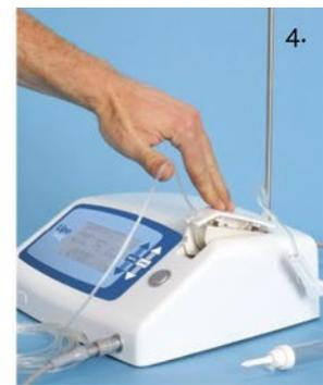
4 Presionar hacia abajo el brazo basculante con el set de tubos montado hasta que encaje.
