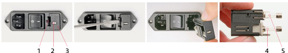
1 Zatvárací mechanizmus priestoru poistiek 2 Zobrazovacie okno pre nastavenie napätia 3 Priestor poistiek 4 Poistka 1 5 Poistka 2
